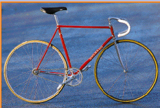
Pisteajoon tarkoitetun ratapyörän mitat: paino 8.2 kg, satulakulma 74 astetta, ohjaus 75 astetta, pituus 55,5 cm, korkeus 57 cm, takahaarukka 40 cm, akseliväli 95 cm.
