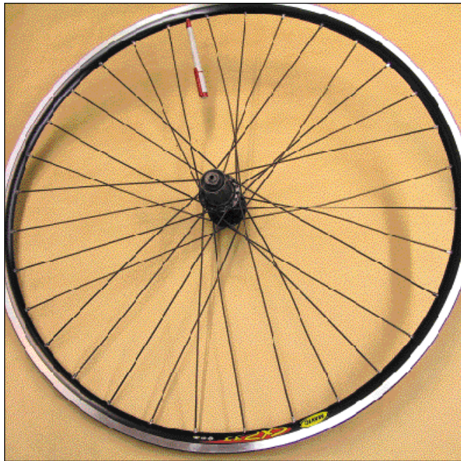
Helppo juttu! Puolat ovat paikoillaan ja venttiilin kohdalla puolat näitesti ojennuksessa. Nyt kiekko on enää pientä rihtausta vaille.
