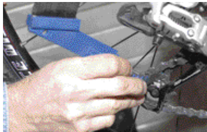
Takavaihtajan pikkurissoista likapaakku irttoa käyttämällä jotakin terävää.
