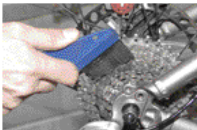
Jos ketju ja rattaat ovat oikein likaiset, kannattaa käyttää jotain vahvempaa liuotinta ja tarkoitukseen suunniteltua harjaa.
