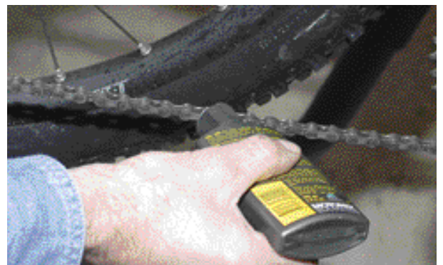
Ketju kannattaa voidella kunnolla. Ylimääräinen öljy pyyhitään rätillä pois, ettei se joudu jarrupinnoille.
