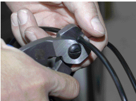
1. Jarruletkujen katkaisuun kannattaa käyttää kunnollisia leikkureita (käytännössä vaijerin-katkaisupihdit), jolloin päistä tulee heti siistit ja suorat.
