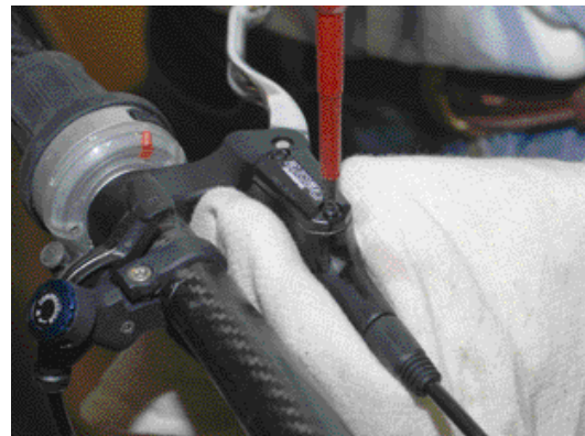
13. Seuraavana on vuorossa systeemin sulkeminen. Ensin asetellaan kumitiiviste paikalleen, sitten kohdistetaan kansi oikeaan paikkaan ja lopuksi kiristetään ruuvit. Käteen kannattaa varata rätiti, ettei ylitsevuotava jarruneste sotke paikkoja.
