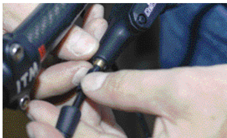
5. Jarrukahvan päässä letku työnnetään paikalleen ja kiristetään tiiviiksi. Viimeiseksi laitetaan muovinen suojus kiristimen päälle.
