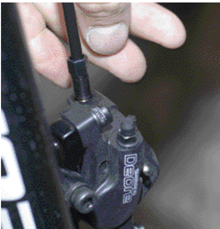
4. Letku työnnetään jarrusatulan reikään ja kiristetään paikalleen. Varmistu oikeasta kiristysmomentista!
